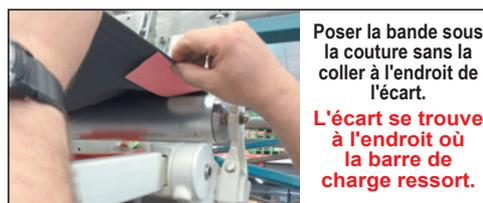
Dans le cas ci-dessus : pour une avancée de 2500 mm et un écart de 25 mm, la bande serait coupée à 180 mm voir tableau ci-dessous
